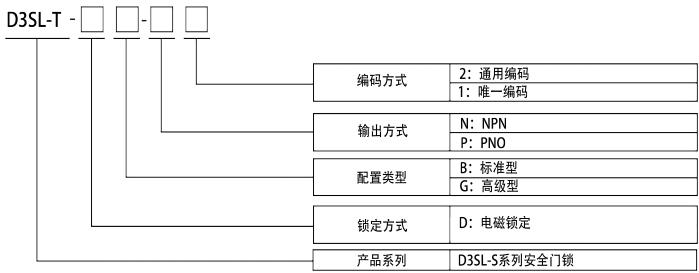
图 4-1 安全门开关型号说明示意图
